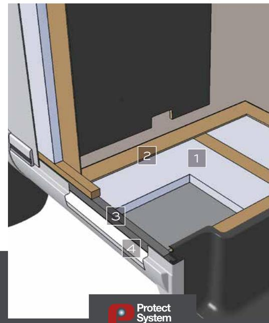
L'isolant XPS Styrofoam (30 mm de Styrofoam pour chaque côté et le plancher) possède des propriétés de haute isolation thermique, phonique, de résistance à l'eau et de légèreté reconnues.
