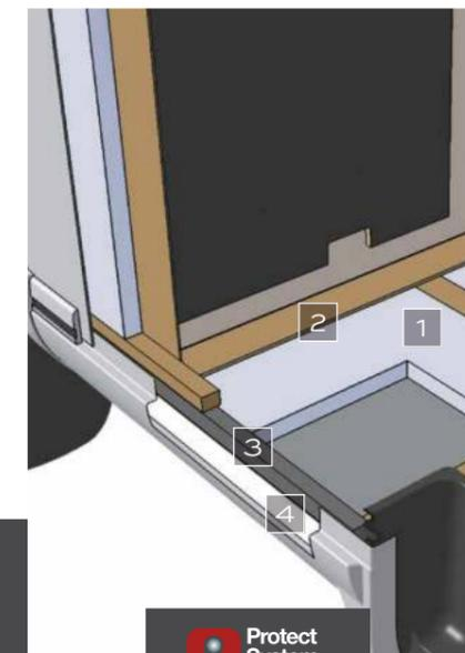
Der Dämmwerkstoff XPS Styrofoam (30 mm Styrofoam in allen Seitenwänden und dem Boden) zeichnet sich durch eine hervorragende Wärme- und Geräuschdämmung, Wasserfestigkeit und sein sehr leichtes Gewicht aus.
