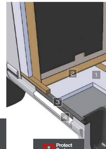
L'isolant XPS Styrofoam (30 mm de Styrofoam pour chaque côté et le plancher) possède des propriétés de haute isolation thermique, phonique, de résistance à l'eau et de légèreté reconnues.
