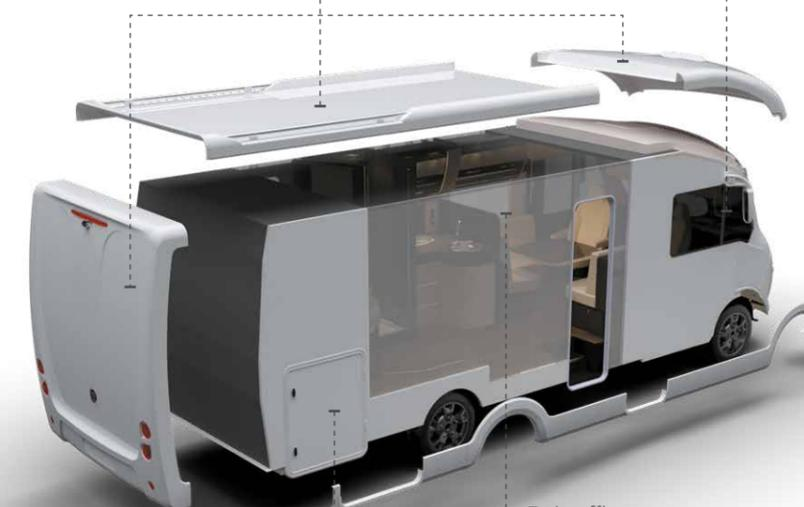
Soute décaissée traversante en polyester sur rallonge de châssis renforcée. Elle est capitonnée et chauffée pour une meilleure isolation.
