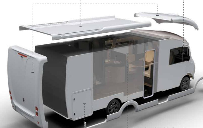
Abgesenkte Polyester-Garage auf verlängertem verstärktem Fahrgestell. Sie ist isoliert und beheizt, für bessere Dämmung.
