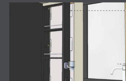
Die in den Wänden eingebrachten Aluminiumeinsätze verleihen der Struktur und dem Mobiliar absolute Stabilität (im Schnitt ca. 150 Befestigungspunkte).
